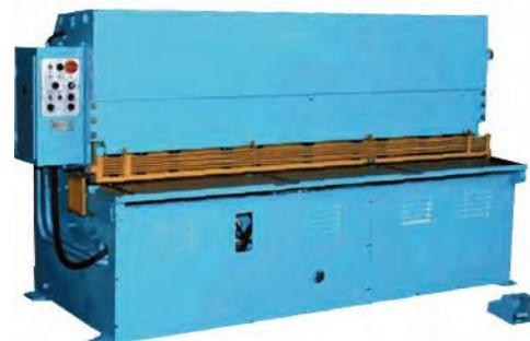
Ножницы (гильотинные) листовые гидравлические с наклонным ножом пред-назначены для резки листового металла.
